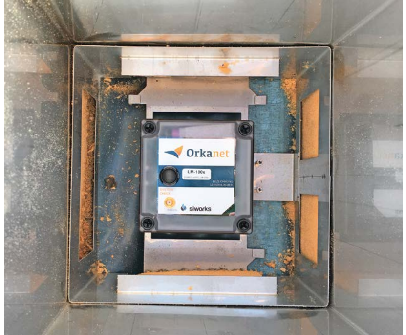
Die Sensorbox schlägt Alarm, sobald Feuchtigkeitswert oder Wasserstand auf Schäden im Dachaufbau hinweisen.
